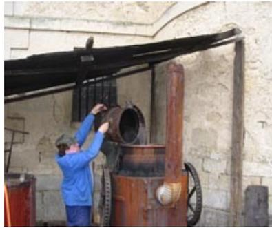
Chargement des produits à distiller dans la cuve de l'alambic
