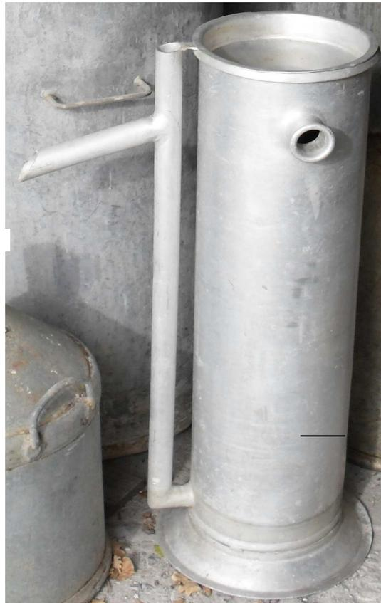
Le tube  $\varnothing$  15-20 mm vertical partant du bas vers le haut, peut être mis à l'intérieur pour moins de fragilité
