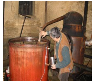
Confection d'un joint de cendres entre le têtard et le serpent
