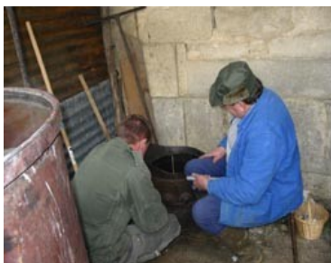
On pèse le taux d'alcool au moyen d'un pèse alcool ou alcoomètre. Il mesure la densité du liquide, son niveau de flottaison indique par lecture directe le pourcentage d'alcool contenu dans le mélange
